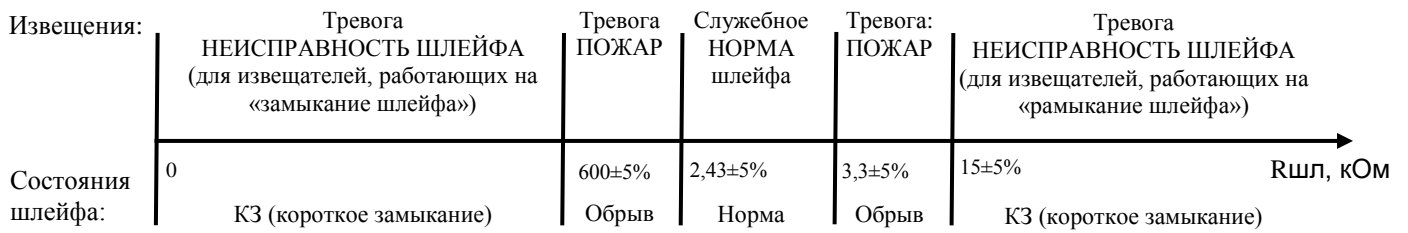
Рисунок Д.1 – Структура активного пожарного шлейфа
